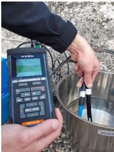
Figure 68 : Prise de température sur un prélèvement d'eau au pont Cessart pendant la campagne
