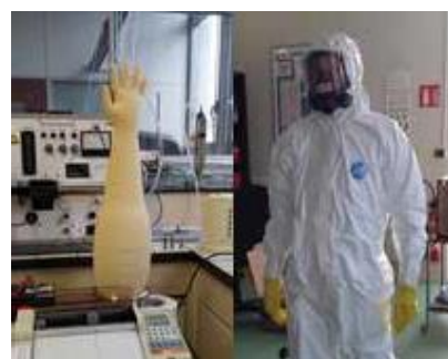
Banc d'essais EPI. Essais avec gant et tenue étanche non ventilée (TENV). Photos : LECEV. Gauche : essais avec tenue étanche ventilée (TEV). Photo : O. Seignette, M. Lafontan/Médiathèque IRSN.
