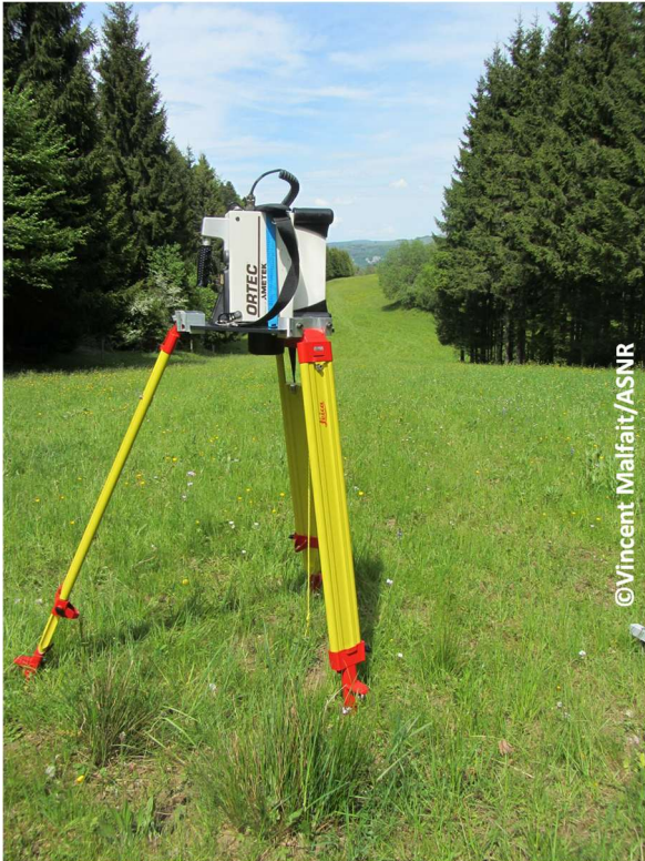
Figure 4 : Appareillage de mesures par spectrométrie gamma in situ .
