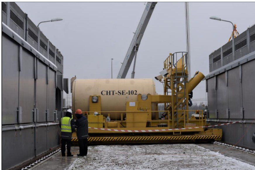
Figure 4 : Transfert d'éléments combustibles usés dans un des modules de l'ISF-2 - Source: SNRIU website 5
