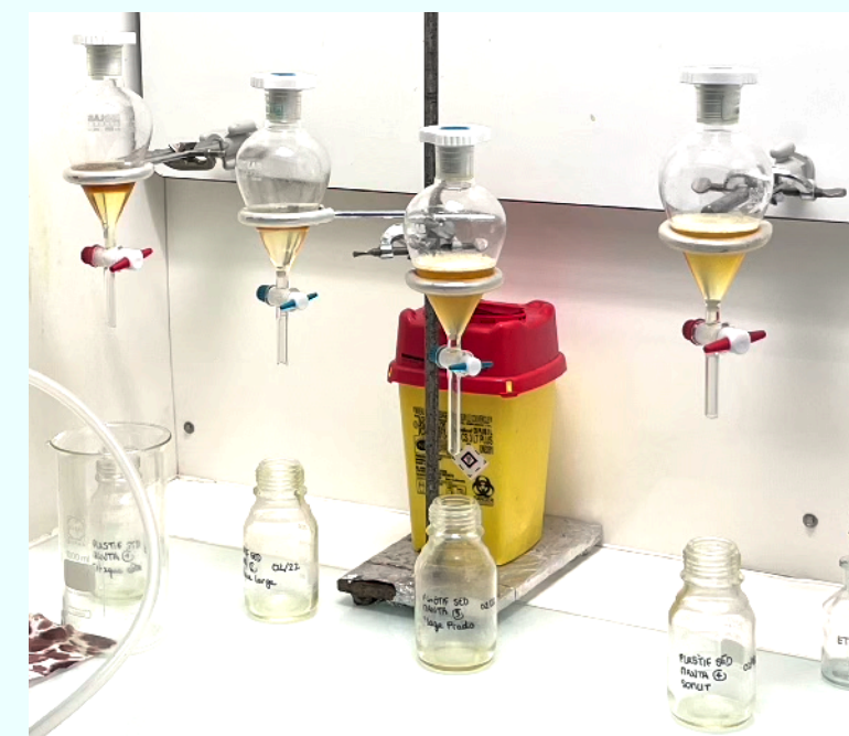
Séparation densimétrique - Matrice + NaI (d=1,6) -
