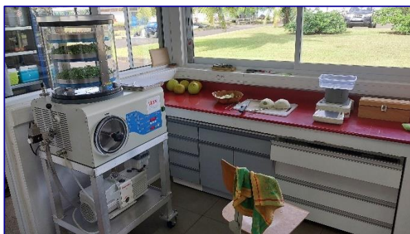
Figure 10 : Préparation par lyophilisation des denrées alimentaires.
