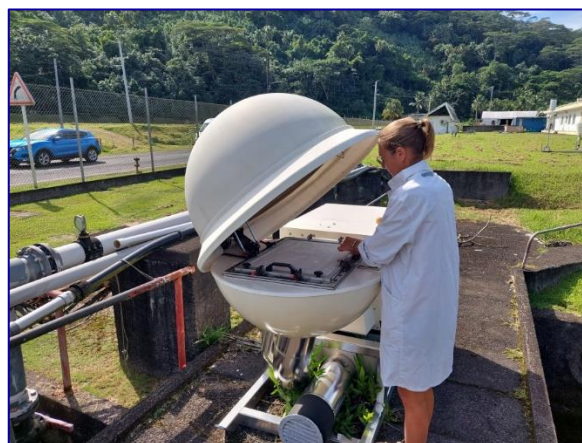
Figure 6 : Station haut débit pour le prélèvement sur filtre des aérosols
