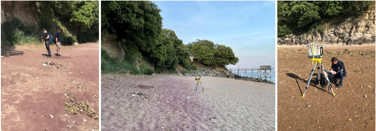
Figure 3. Photographies des mesures par un dispositif mobile (à gauche) et par spectrométrie gamma in situ sur la plage de Trébézy (au milieu et à droite).
