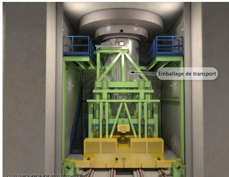
Figure 13. Emballage de transport positionné sur la réhausse (-11 m) et accosté à la cellule supérieure de déchargement (+0 m) par la trappe d'accostage [35].
