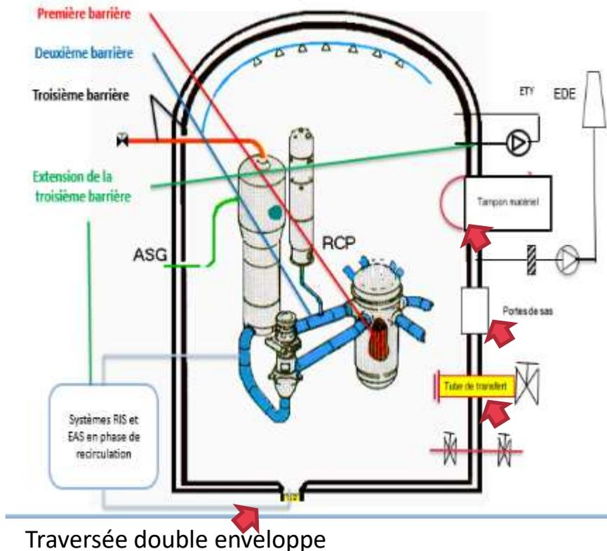
Les fuites qui arrivent via les parois de l'enceinte interne dans l'EEE sont collectées et filtrées par **le système EDE** (système de mise en dépression de l'EEE) avant rejet à la cheminée
