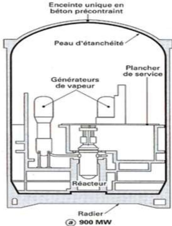
**900 MWe** : Enceinte à simple paroi en béton pour résister à la pression avec peau d'étanchéité métallique
