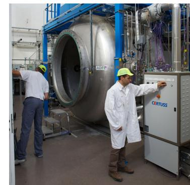
L'installation PEARL permettra d'étudier les écoulements multi-dimensionnels et les effets de la puissance résiduelle dans des conditions représentatives d'un réacteur accidenté. Les choix technologiques et l'instrumentation ont été qualifiés grâce à l'installation PRELUDE, plus petite.
