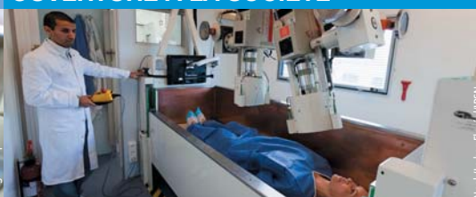
17. Le laboratoire mobile d'anthroporadiométrie de l'IRSN permet de suivre in situ les professionnels exposés.
