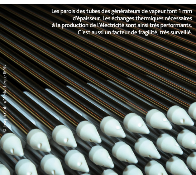
Le générateur de vapeur (GV) refroidit le cœur du réacteur et contribue à la production électrique. Remplacement d'un GV de la centrale de Cruas-Meysses (Ardèche).
