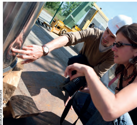
L'expert observe la déformation du colis à la suite de l'essai de chute.
