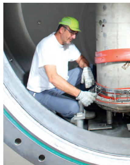
L'installation Pearl, située à Cadarache (Bouches-du-Rhône), est utilisée pour étudier la progression du corium.
