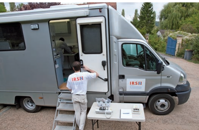
À bord d'un camion-laboratoire, les experts de l'IRSN effectuent une analyse immédiate et "in situ" des éléments prélevés sur place.
