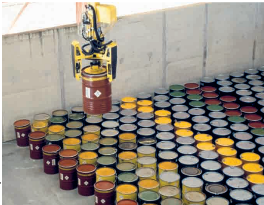
Stockage de fûts métalliques au centre de l'Andra dans l'Aube (déchets de faible et moyenne activité).
