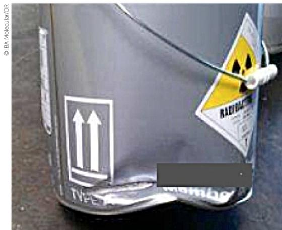
**Figure 2.11** / Colis de type A endommagé lors d'une manutention.
