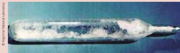
Figure 2.16 / Cristaux d' $UF_6$  contenus dans une ampoule de verre.
