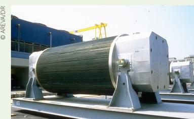
Figure 1.8 / Exemple de colis de type B.
