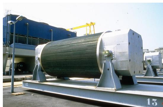
**Figure 2.13** / Colis de type B utilisé pour le transport d'assemblages combustibles irradiés.
