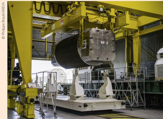
**Figure 4** / Chargement d'un colis de combustible irradié sur un châssis de transport.
