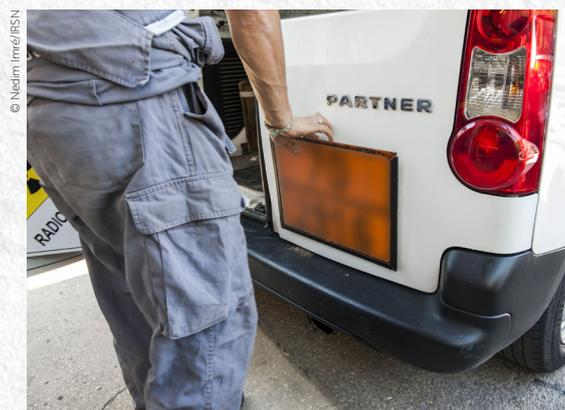
**Figure 8** / Pose de signalisation obligatoire relative au transport d'un colis de substances radioactives de forte activité.
