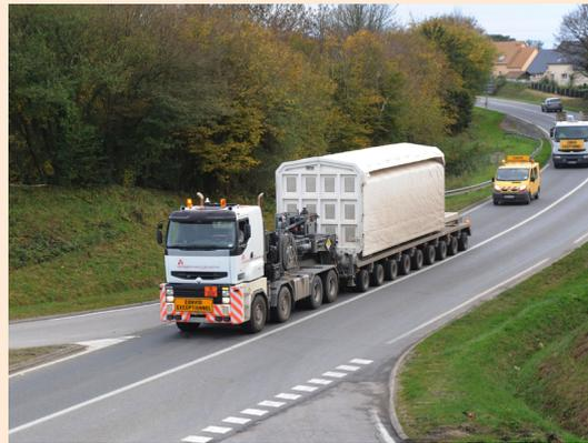
**Figure 5** / Transport par camion d'un colis de combustible irradié.
