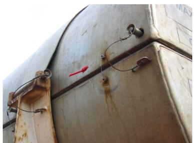
**Figure 2.19 /** Constat de désengagement d'une broche à billes.
