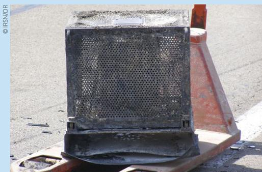
**Figure 4.6** / Vue du colis accidenté muni de sa coque extérieure de protection.
