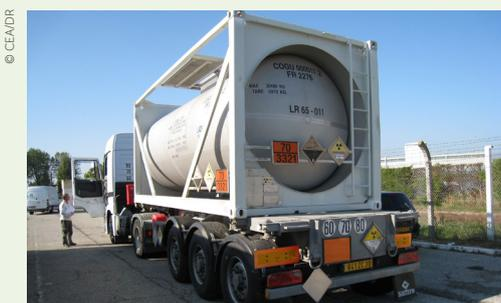
Figure 1.6 / Exemple de colis de type IP.
