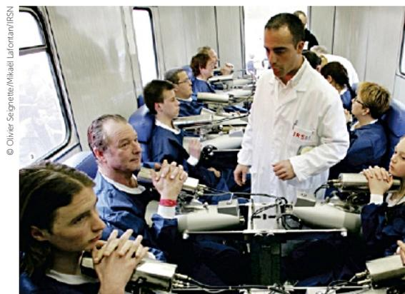
Figure 4.3 / Camion laboratoire d'anthropo-radiométrie (mesure de la radioactivité retenue dans l'organisme).
