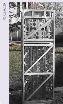
Le modèle de colis TN-BGC 1, de type B selon la réglementation, est constitué d'un corps de forme cylindrique, d'un diamètre d'environ 30 cm et d'une longueur de 1,80 m. La protection du colis en cas de choc est assurée par une cage en aluminium de forme parallélépipédique de 60 cm de côté (figure 3.1) ainsi que par un capot de protection constitué de balsa, de forme cylindrique, qui équipe la partie supérieure de l'emballage.
