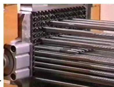
Vue d'une partie du squelette (grille et tirants maintenus) sur le banc TGM
