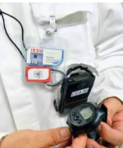
Exemple de dosimètres portés par les opérateurs en zone contrôlée
