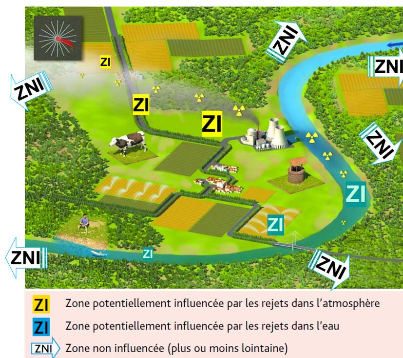
**Figure 2 : Schéma des zones potentiellement influencées (ZI) ou non (ZNI) par les rejets d'une installation ayant des rejets atmosphériques et des rejets liquides dans un fleuve (source IRSN)**
