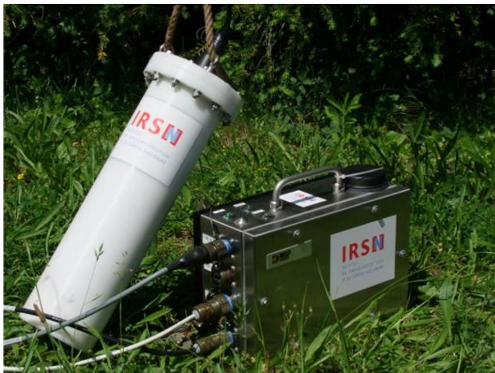
*Figure 23 : Exemple de sonde de spectrométrie gamma (nouvelle génération) de l'IRSN pouvant être utilisées dans l'environnement atmosphérique, terrestre et aquatique*
