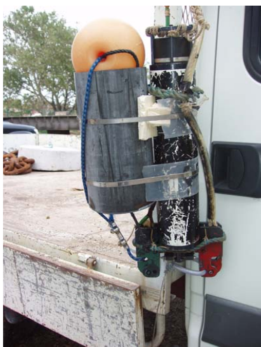
Les largueurs utilisés pour les altimètres en mer
