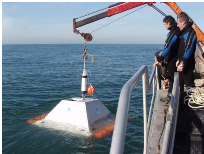
Mise à l'eau de l'ADCP de 40 m
