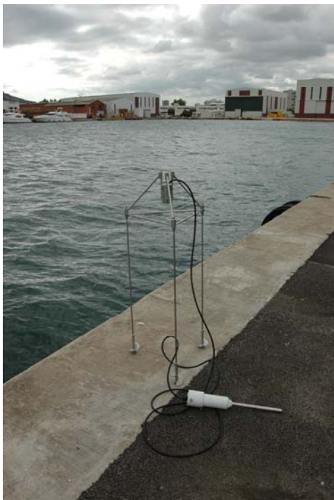
Altimètre monté sur son support trépieds.
