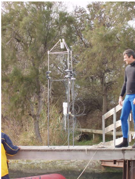
Altimètre implanté dans le Rhône sur une structure en fers à béton.
