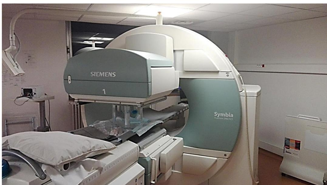
Figure 6-3 - Gamma-caméra Symbia T de l'hôpital Cochin avec le fantôme NEMA et le flacon placés sur la table d'examen.
