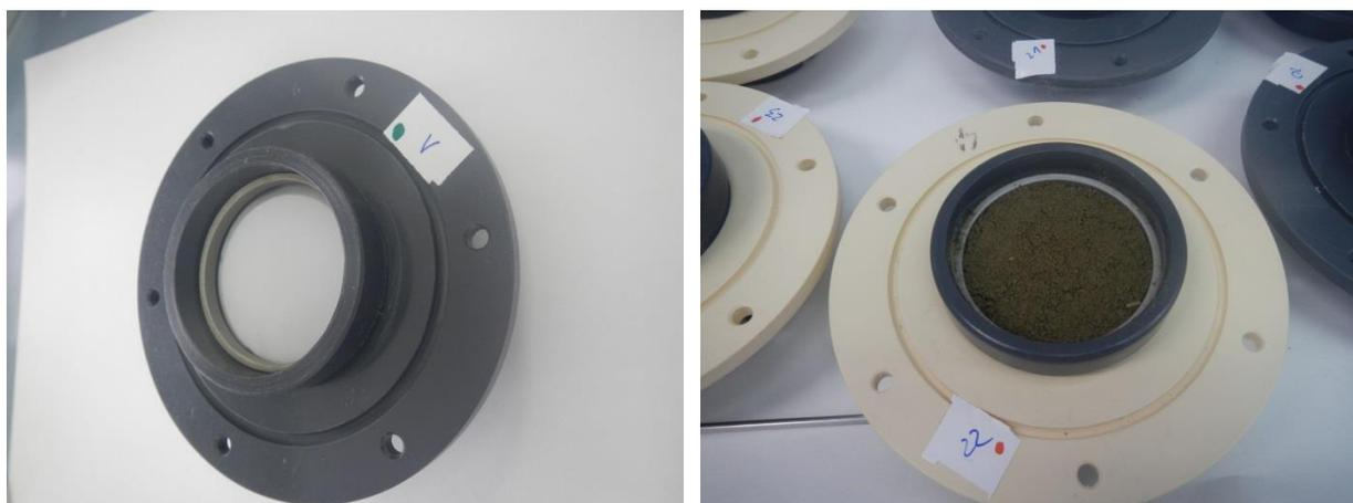
*Figure II.8 : Photos de la partie intermédiaire de rhizotests avant et après remplissage de sol.*
