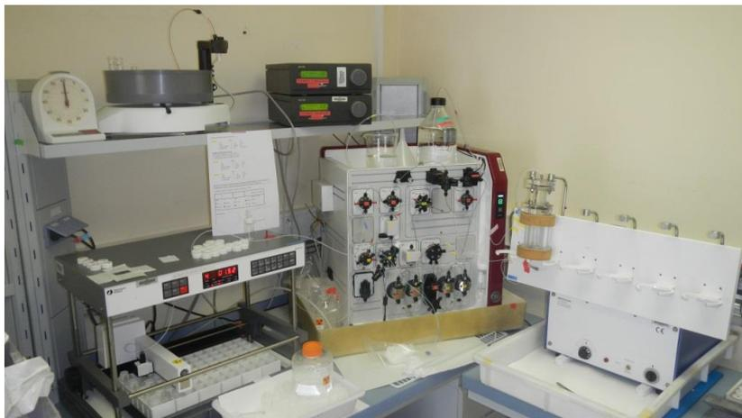
**Figure II.4 :** Montage expérimental permettant de fonctionner le réacteur à flux ouvert parfaitement agité à flux continu. Ce dispositif se compose entre autres (de droite à gauche) : d'un agitateur à bascule accueillant le réacteur, d'un automate de chromatographie regroupant les pompes d'alimentation, différentes vannes (ex. inversion de flux, commutation de voies) et des capteurs physico-chimiques, de collecteurs de fractions.
