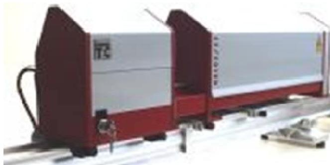
**Figure 8 : Granulomètre laser à diffraction**
