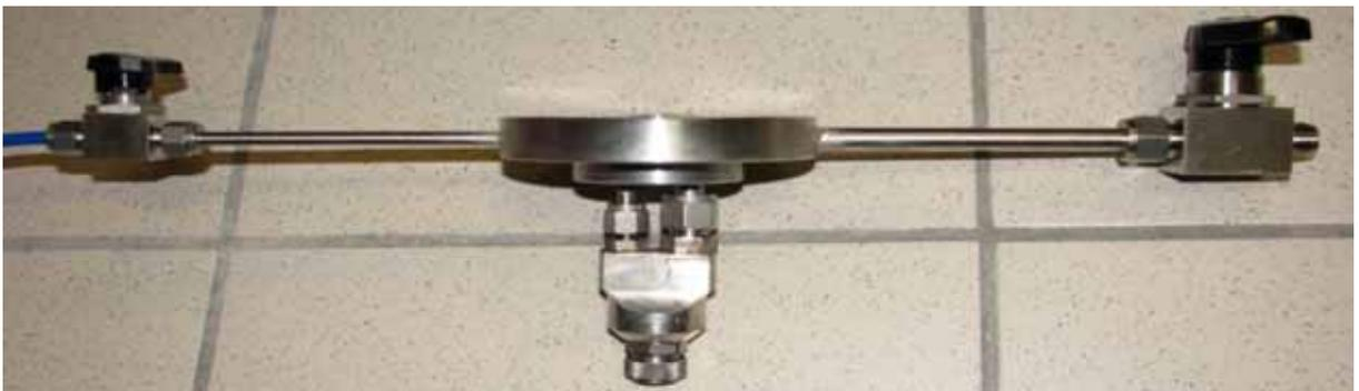
Figure 30 : Injecteur bi-fluide monté sur son support
