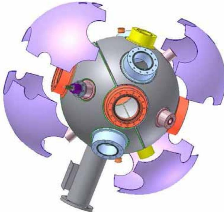
Figure 26 : Vue éclatée de la seconde enveloppe de la bombe sphérique.
