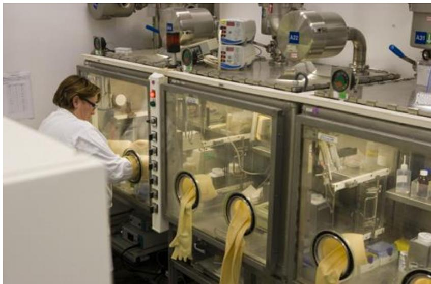
**Figure 1.** Boîte à gants dans une installation nucléaire - Crédit : Noak/Le Bar
