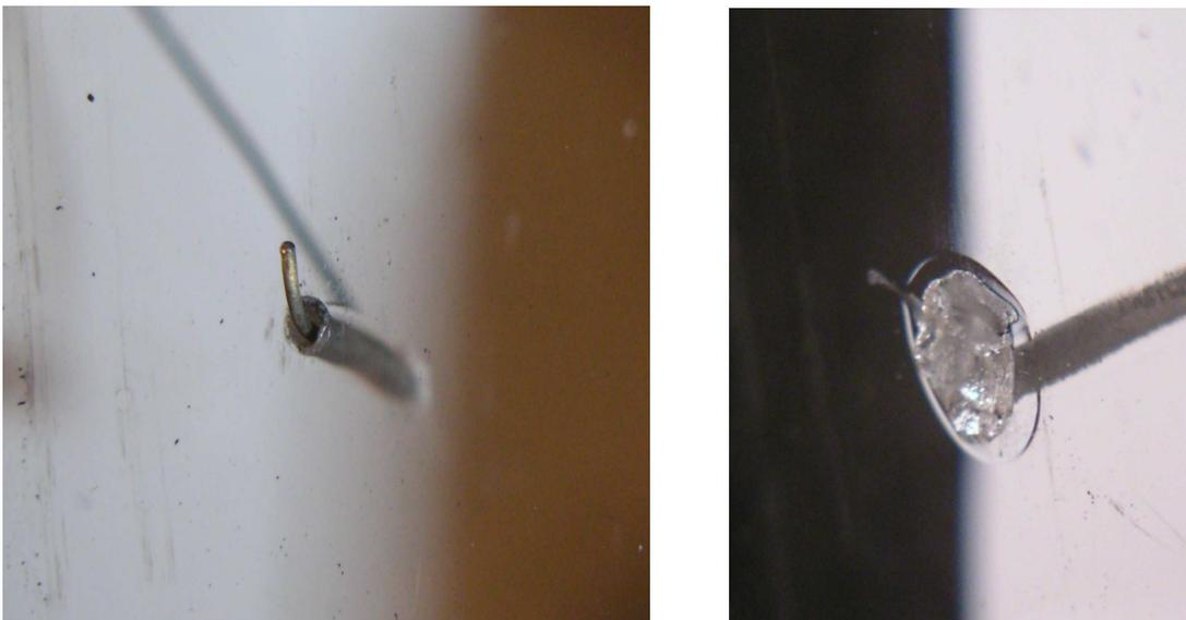
Figure 21 : Technique d'implantation des thermocouples à la surface de la plaque combustible.
