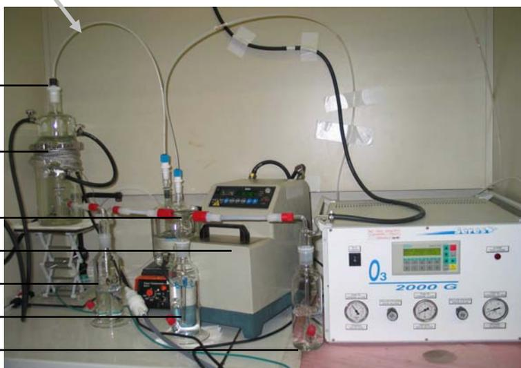
Figure 30 : Dispositif expérimental pour l'étude de l'oxydation des dépôts de ruthénium sous l'action de l'ozone.
