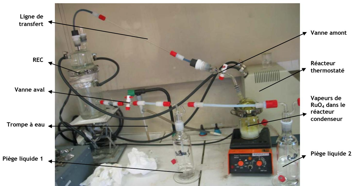
Figure 26 : Dispositif expérimental pour l'étude de la stabilité de RuO<sub>4</sub>(g).
