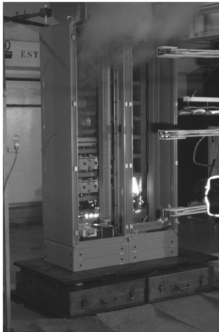
Figure 7.4. Feu d'une armoire électrique utilisée dans des installations du cycle du combustible réalisé dans l'installation SATURNE, dans le cadre du programme PICSEL. © Florent-Frédéric Vigroux/IRSN.
