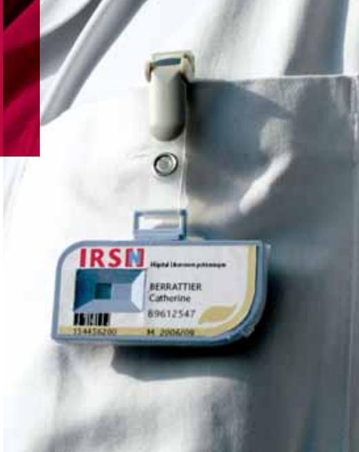
Prototype du dosimètre RPL.
