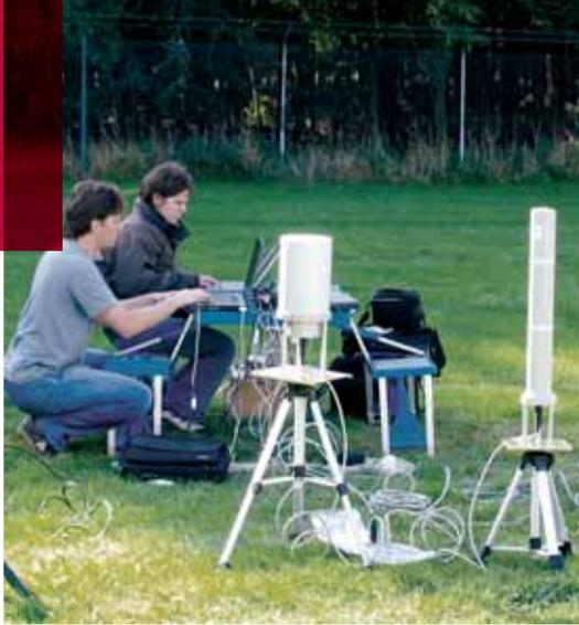
L'unité en charge de la télésurveillance à l'IRSN teste actuellement plusieurs types de balise.
