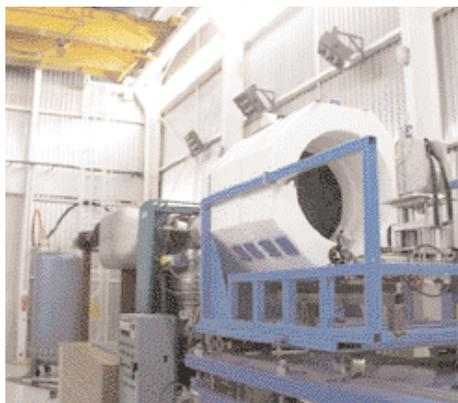
*L'IRSN dispose de moyens uniques en France pour la dosimétrie des neutrons : ici le dispositif modérateur CANEL.*
