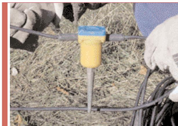
Géophone utilisé pour l'enregistrement sismique.
