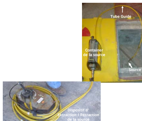
Figure 11 : Gammagraphie : Pour radiographier une soudure, l'opérateur doit à distance extraire la source radioactive de son container grâce à un dispositif de câble entraîneur sur enrouleur manuel. La source poussée jusqu'à l'extrémité du tube guide est en position d'irradiation. Une fois la radiographie effectuée, la source est ramenée dans son container. Dans le cas de l'accident du Chili la source s'est désolidarisée de son câble et est tombée du tube guide.
