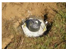
Figure 5 : Installation lors de la mission LIA d'un sismomètre et d'un panneau solaire (gauche). Accéléromètre implanté sur une dalle préfabriquée (haut)
