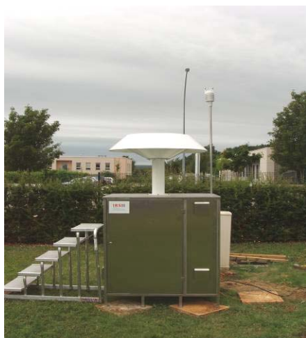
Réseau OPERA-Air de l'IRSN : station de collecte d'aérosols à très grand débit (TGD)
