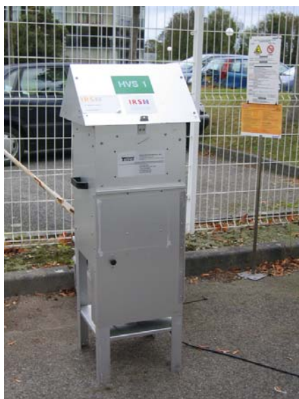
Station de collecte d'aérosols de débit intermédiaire (80 m 3 /h)
