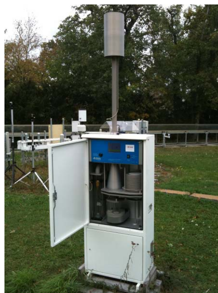
Station de collecte d'aérosols de débit intermédiaire (60 m 3 /h)
