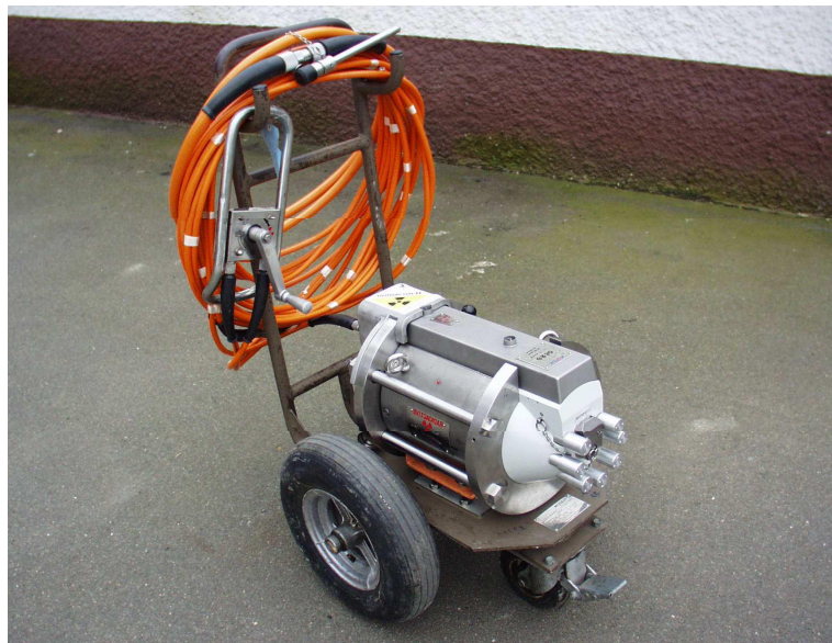
Figure 1. Gammagraphe de modèle GR-100 similaire à celui impliqué dans l'incident du 11 mai 2017. Le conteneur blindé permet de stocker la source radioactive de cobalt-60 en position de sécurité permettant la manipulation et le transport de l'équipement. Lors de l'utilisation du gammagraphe, la source est sortie de son conteneur puis déplacée dans la gaine d'éjection flexible orange jusqu'au poste d'irradiation.
