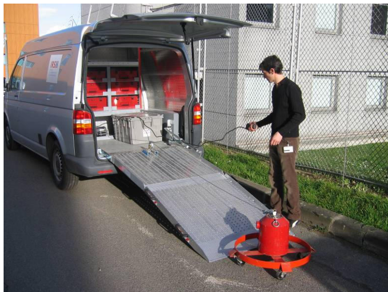
Figure 1 : Conteneur blindé pour la mise en sécurité et le transport de source radioactive en cours de chargement dans un des véhicules d'intervention de l'IRSN
